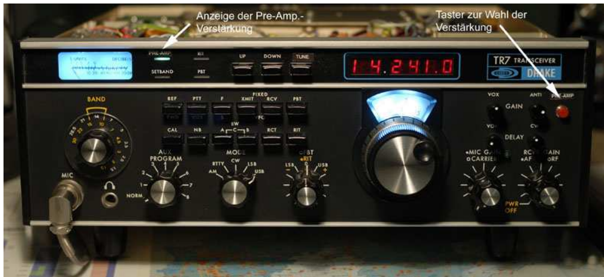
Frontplatte nach Einbau des Vorverstärkers. Links oben die Anzeige-LED. Rechts der Umschalter für die Verstärkungsstufen.
