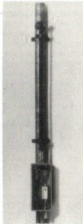
Bild 8: Die Vorverstärker/ Relais-Baugruppe aus Bild 5 an einem koaxialen Anpaß- transformator be- festigt
